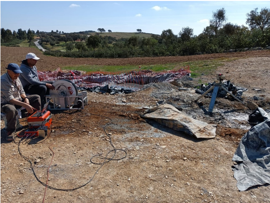
Foto 1: Equipo geofísico de sondeo electromagnético borehole de IGT trabajando en el yacimiento de La Romanera
